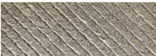
Die 45-Grad-Ausrichtung der Schweißraupen zur Förderrichtung verursacht einen geringen Verschleiß. Sowohl die Nahtübergänge wie auch die Härterisse verlaufen schräg in einem Winkel von 45 Grad zum Förderstrom und schützen so das Bauteil vor Verschleiß.
