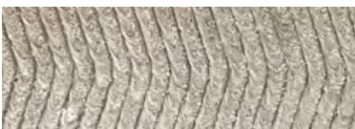
Bei der Förderung von hochabrasiven Medien zeigen sich an hochverschleißfesten Beschichtungen die Verschleißspuren oft an den Nahtübergängen (Überlappung oder in den Spannungs-/ Härterissen). Bei hoher Fördergeschwindigkeit von sehr abrasiven und feinen Partikeln hat die Raupenschweißung in Sinusform hervorragende Verschleißschutzigenschaften erzielt.
